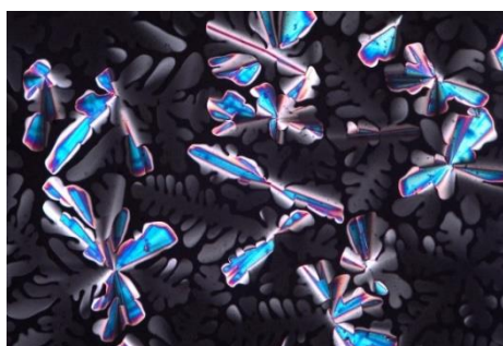
Figura 1.- Microfotografía de la mesofase Col h del compuesto de coordinación de Pd(II) tomada a 294 °C durante el ciclo de enfriamiento.
